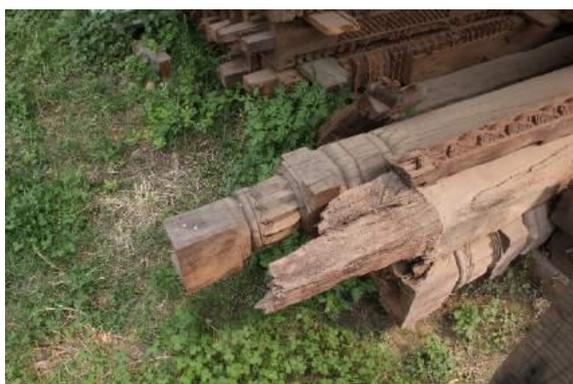
*Figura 46: Madera dura dura podrida en la base de una columna que se había vertido en el hormigón, después de la extracción*
