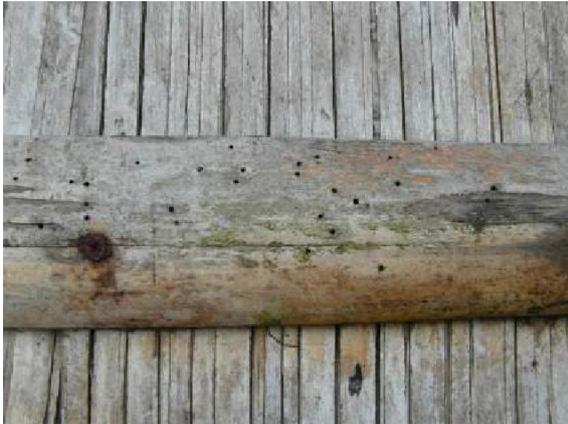
*Figura 30: Daño de escarabajo en bambú, Ecuador - los agujeros de salida son claramente visibles (Kaminski, 2016)*
