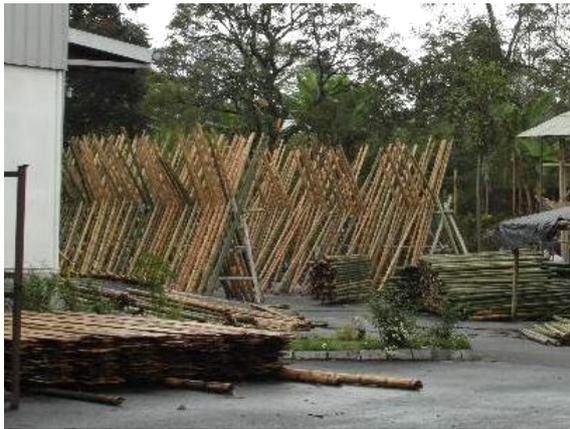
Figura 44: Secado al aire de bambú afuera, Colombia (Kaminski, 2016)
