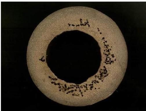
*Figura 36: Corte transversal a través de bambú dañado por insectos (Trujillo, 2014)*
