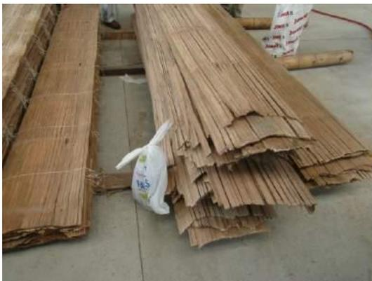
*Figura 6: Esterilla (Colombia) o caña picada (Ecuador): láminas de bambú formadas por la apertura / división física de un culmo de gran diámetro a lo largo y luego desenrollado (Kaminski, 2016)*
