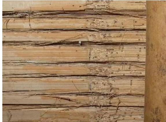
*Figura 31: Daño de escarabajo en bambú, Colombia - los agujeros de salida son claramente visibles (Kaminski, 2016)*
